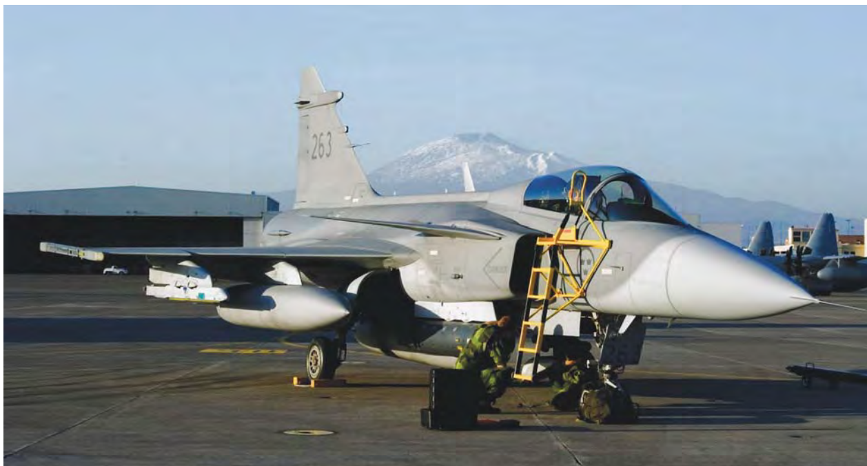
Подготовка истребителя JAS 39С к полету. На самолете подвешен контейнер «Лайтенинг», контейнер с разведывательным оборудованием и два ПТБ
